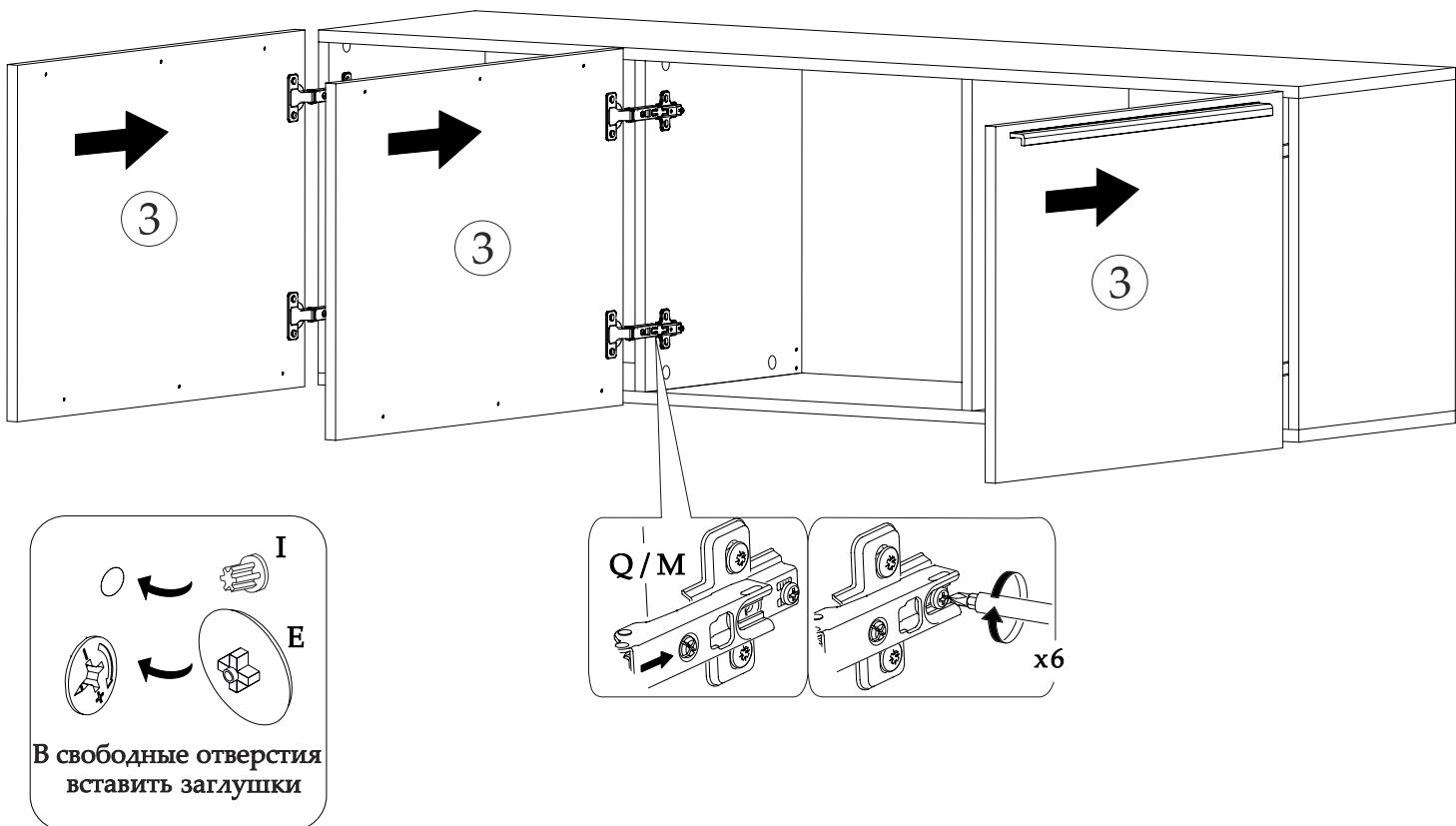
Схема регулировки петель
