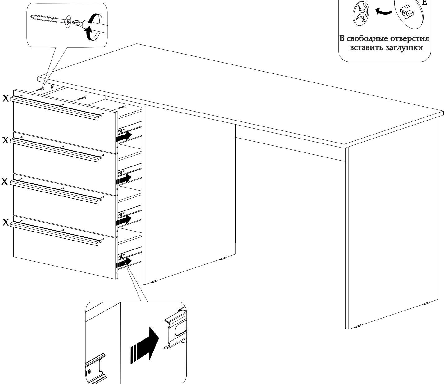
При наличии рядом стоящего изделия необходимо стянуть их между собой с помощью межсекционной стяжки, предварительно просверлив сквозные отверстия-Ø5.
