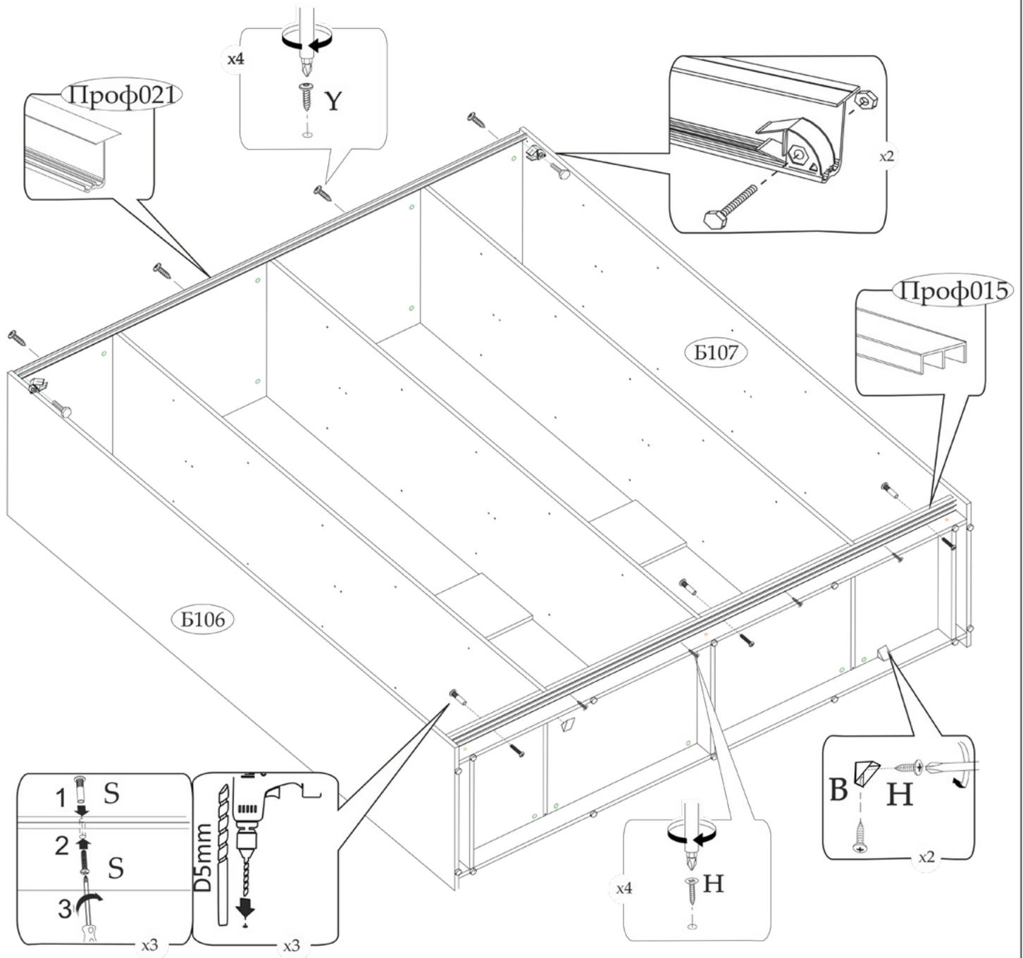
Нижняя направляющая устанавливается вровень с вязкой, дополнительно фиксируется шурупами 4x16
