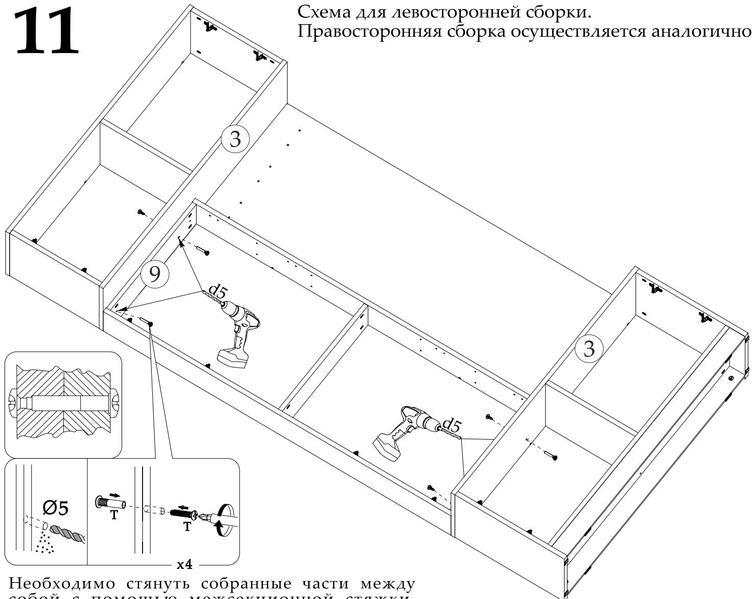
Необходимо стянуть собранные части между собой с помощью межсекционной стяжки, предварительно просверлив сквозные отверстия-Ø5.
