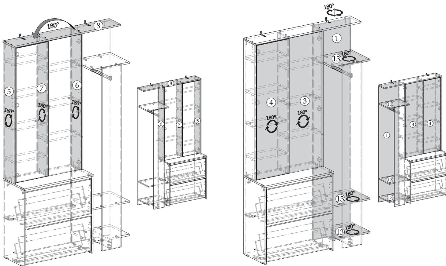
Детали № 1, 3, 4, 5, 6, 7, 8, 13 с универсальной сверловкой, поэтому в зависимости от стороны сборки их можно переворачивать на 180 град.
