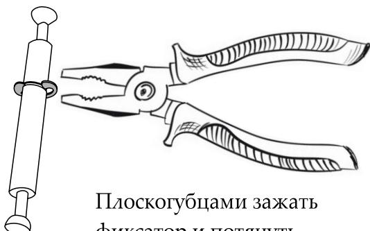
Плоскогубцами зажать фиксатор и потянуть
