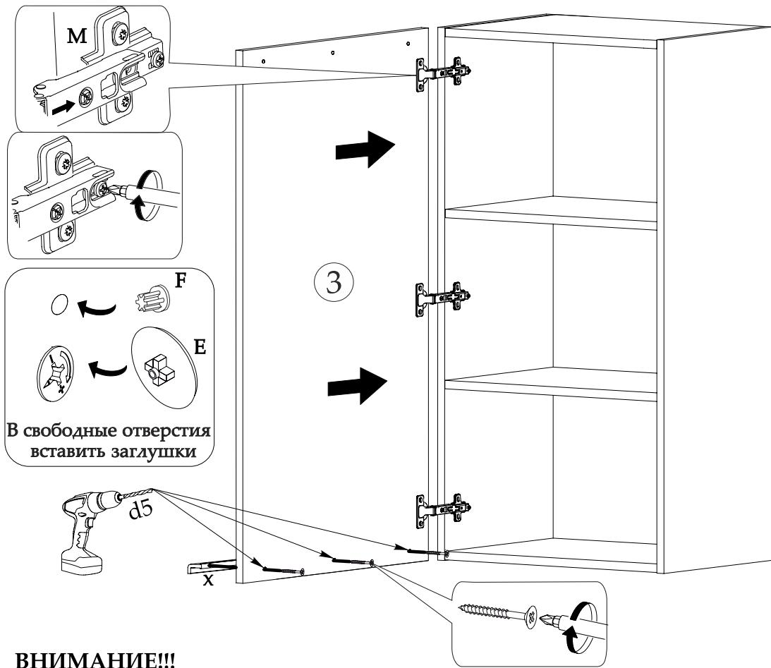
Схема регулировки петель
